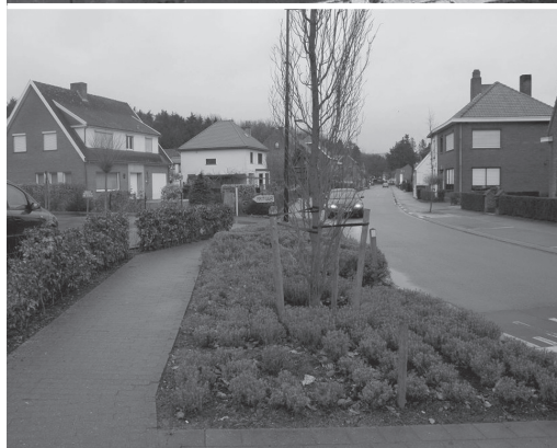
Boven: Goed bedoeld maar hopeloos (1). Deze boom in de Kpt. Maenhoutstraat heeft ondergronds onvoldoende ruimte om ooit volwassen te worden. Voldoende wortelruimte moet voorzien worden bij de start van het planningsproces en niet op het einde zoals nu nog het geval is. Onder: Goed bedoeld maar hopeloos (2). Hier stond tot voor kort een monumentale beuk. Het fietspad werd rond de boom gelegd, maar hierbij werden de wortels beschadigd. Gevolg: de boom stierf kort nadien en moest vervangen worden.
